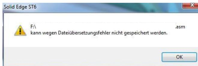
Dies liegt an Geometriefehlern in einem oder mehreren Einzelteilen. Mittels des Werkzeugs *Geometrieprüfung* (Register *Prüfen* -> Gruppe *Bewerten* -> *Geometrieprüfung*) können Einzelteile oder Teile auf der obersten Baugruppenebene auf Fehler analysiert werden.
